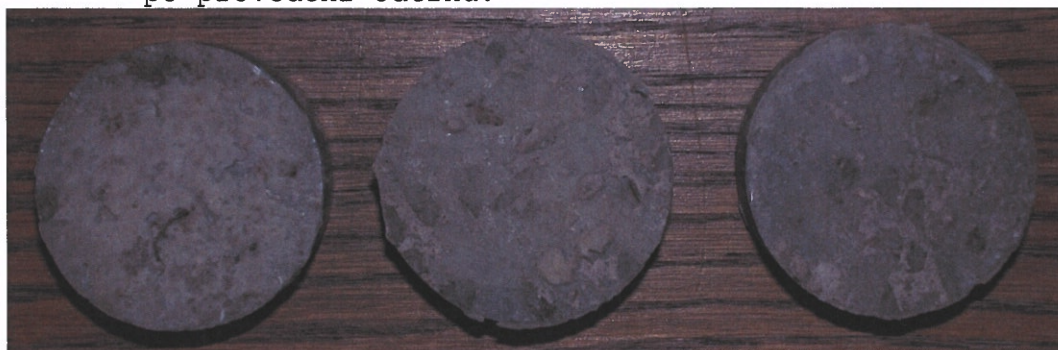
Obr.F47-113 Zkušební terče číslo 126, 6, 29 (zkušební místo 3) po provedení odtrhu.
