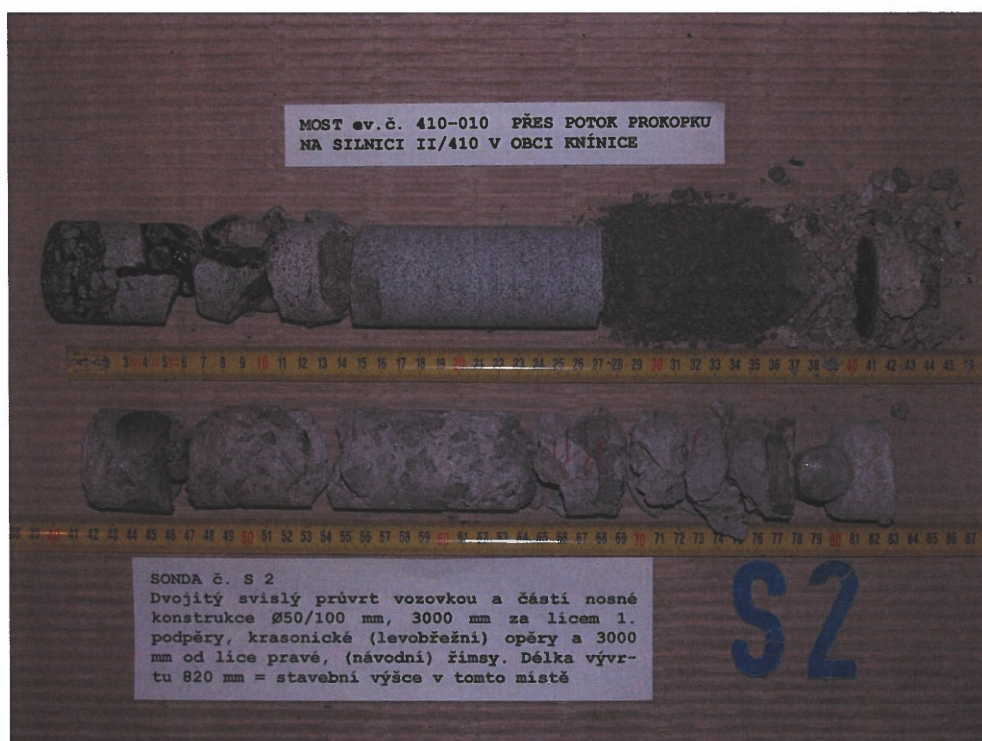
Obr. F47-2 SONDA S2. Dvojitý svislý průvrt vozovkou a částí nosné konstrukce Ø50/100 mm, 3000 mm za lícem 1. podpěry, krasonické (levobřežní) opěry a 3000 mm od líce pravé (návodní) římsy. Délka vývrtu 820 mm odpovídá stavební výšce v tomto místě.
