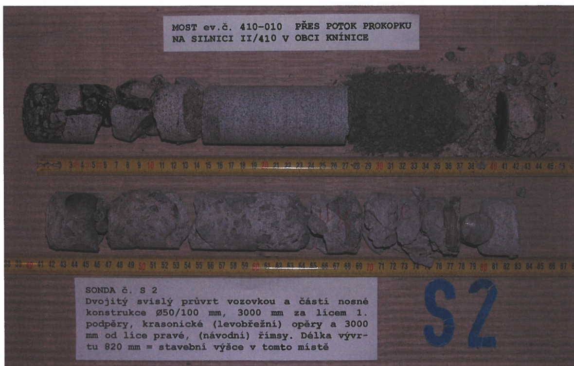
Obr.F47-102 Sonda č. S2. Dvojitý svislý průvrt vozovkou a částí nosné konstrukce Ø50/100 mm, 3000 mm za lícem 1. podpěry, krasonické (levobřežní) opěry a 3000 mm od líce pravé (návodní) římsy. Délka vývrtu 820 mm odpovídá stavební výšce v tomto místě.
