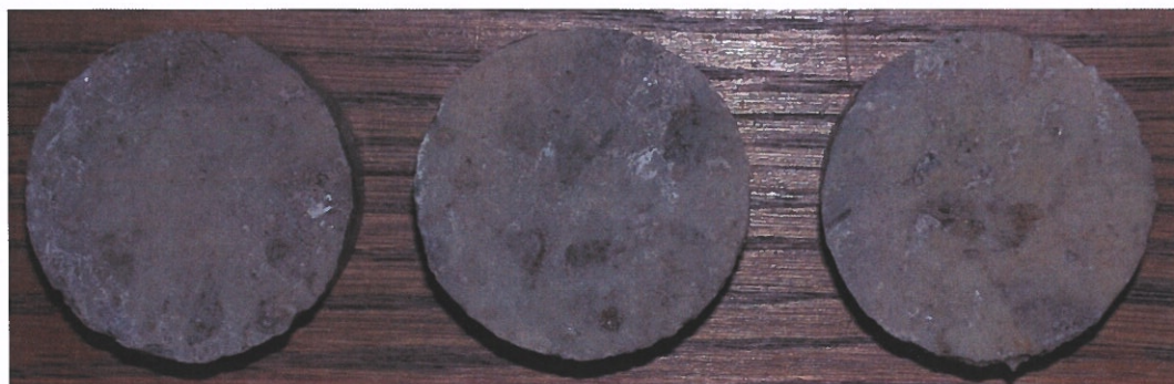
Obr.F47-111 Zkušební terče číslo 129, 22, 116 (zkušební místo 1) po provedení odtrhu.
