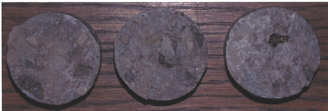
Obr.F47-112 Zkušební terče číslo 31, 77, 58 (zkušební místo 2) po provedení odtrhu.
