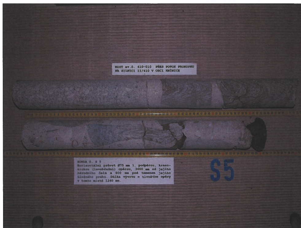
Obr. F47-3 SONDA S5. Horizontální průvrt \varnothing 75 mm 1. podpěrou, krasnickou (levobřežní) opěrou, 3600 mm od jejího návodního čela a 800 mm pod temenem jejího úložného prahu. Délka vývrtu, odpovídající tloušťce opěry v tomto místě je 1260 mm.
