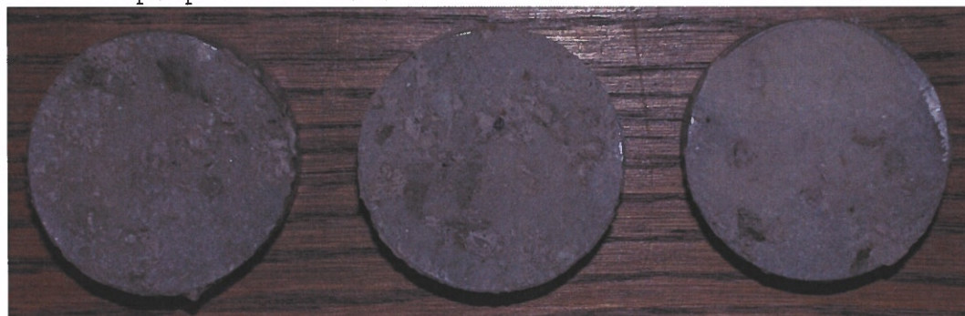
Obr.F47-114 Zkušební terče číslo 76, 134, 117 (zkušební místo 4) po provedení odtrhu.
